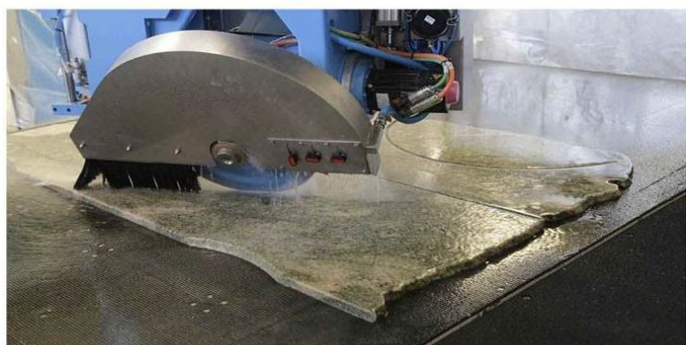
端が直線ではないスラブでの曲線切断
