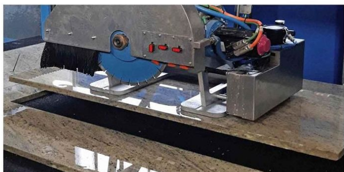
AVS: オンボード真空システムによるスラブの移動
